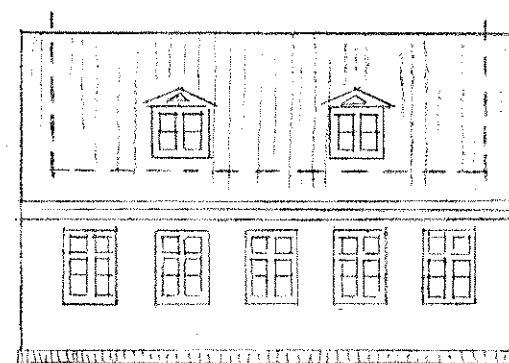
Kviste holdes mindst 3 tagsten inde fra gavl og over tagfod
