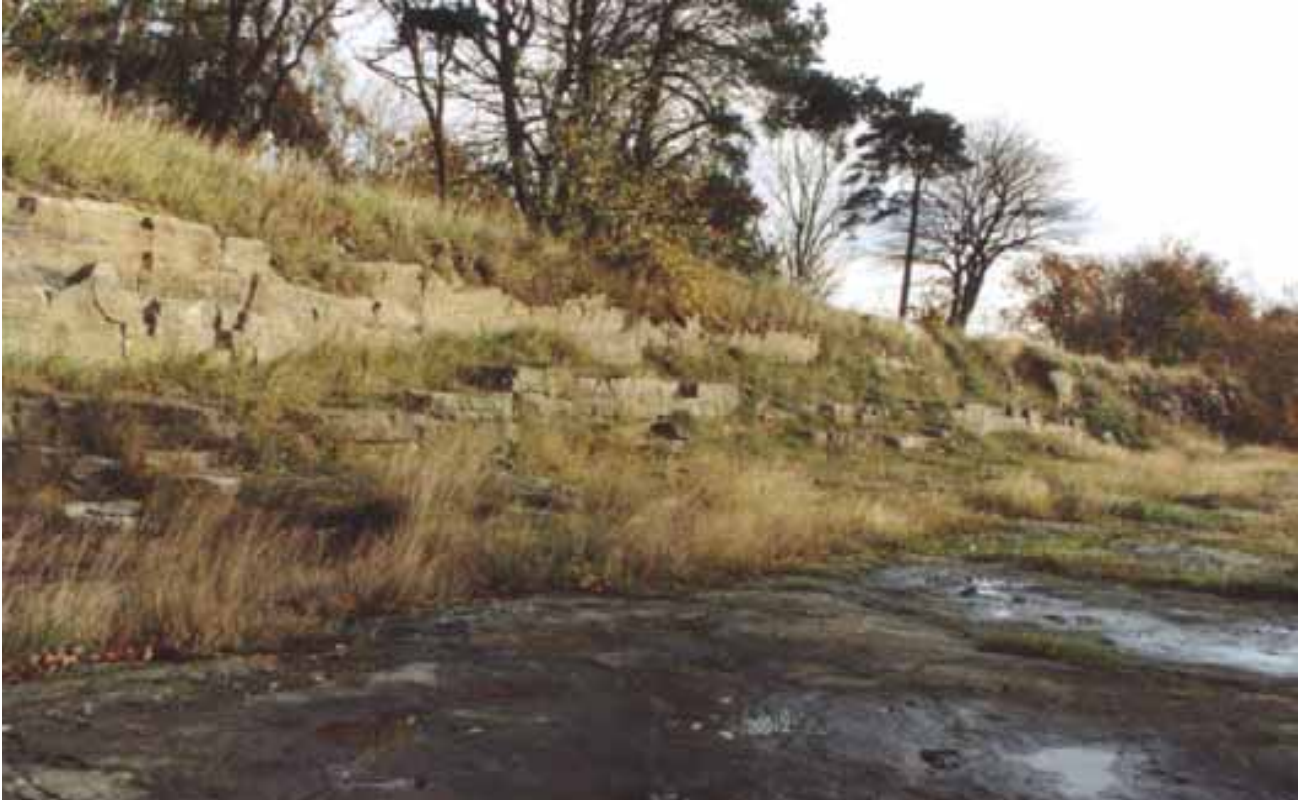
Balkasandsten i Smålyngen Stenbrud i Pedersker. En hård sten der ikke kan brydes i store tykkelser.
